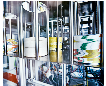
Bild 1. Die IML-Anlage entnimmt pro Prozessschritt jeweils sechs Label aus einem Magazin, um sie in das offene Spritzgießwerkzeug einzulegen © Beckhoff Automation
